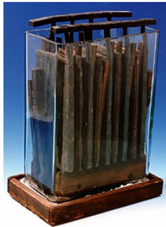
Obr. 3 – Plantéuv akumulátor.
