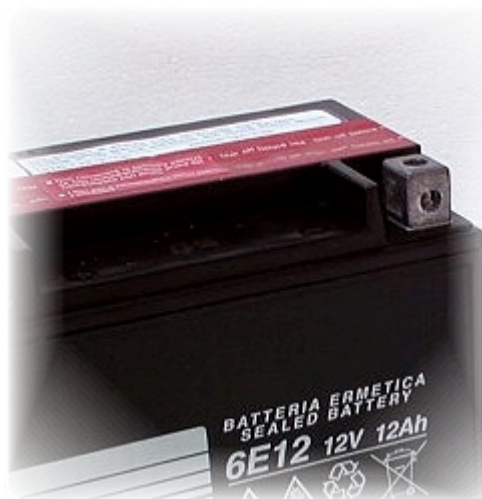
Obr. 34 – detail bezúdržbového, MF akumulátoru. Žádné dolévací zátky, žádná odvětrávací hadička, kontejner z černého plastu. V případě startovacích akumulátorů znak bezúdržbového provedení.
