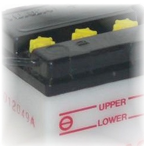
Obr. 32 – typické provedení údržbového akumulátoru. Zátka pro dolévání destilované vody, odvětrací hadička, kontejner z mléčného, poloprůhledného plastu umožňující inspekci hladiny elektrolytu, s vyznačením minimální a maximální hladiny.
