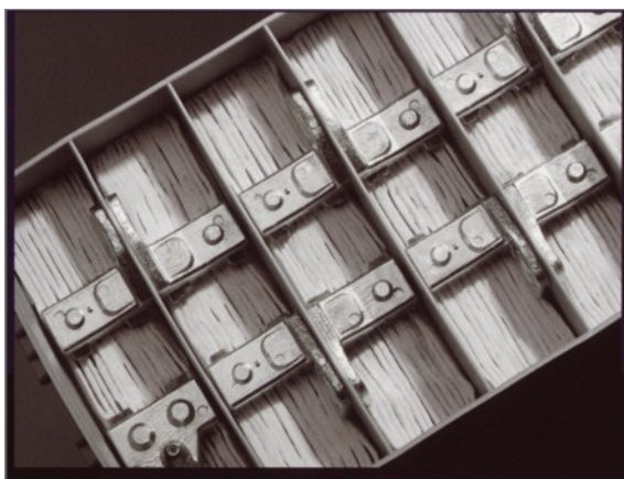
Obr. 4—pohled pod víko do akumulátoru
