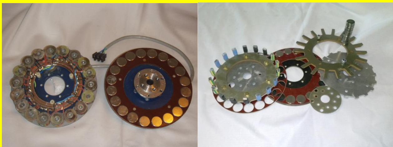
Vľavo rozložený AR200, vpravo diely na AR300. Zľava doprava: armatúra statora s ohnutými pólovými nastavcami (tými nešťastnými jadrami), pod ňou pertinaxová matrica pre fixáciu magnetov na kotúči rotora. Uprostred kotúč rotora s maticou a ukážkou s magnetmi, vpravo hore sada plechov ešte pred ohnutím nastavcov a úplne vpravo doska -nosič statora z duralu, ktorý slúži aj na ohýbanie nastavcov, vpredu dole dištančná podložka pre nastavenie vzduchovej medzery.
