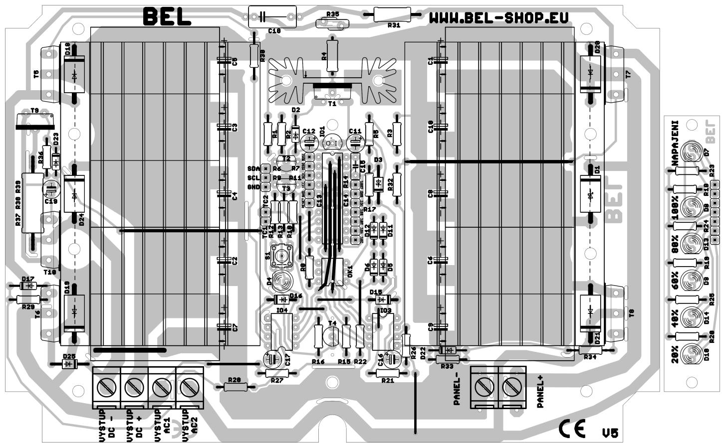
Rozměry větší desky jsou 180,34 x 120,65 mm, rozměry menší desky jsou 15,24 x 76,2 mm. Pozor v desce jsou na některých mís-tech malé otvory těsně vedle, které vytvářejí izolační můstky v mís-tech, kde jsou vedle sebe blízko spoje v s velkým rozdílem napětí. Tyto izolační drážky je nutné vytvořit i při domácí výrobě desky. K pájení lze použít pistolovou páječku s pájecí smyčkou z drátu o průměru 0,7 mm a 1,5 mm, nebo mikropáječku.
