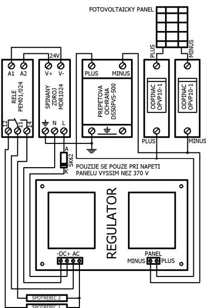
**Třetí režim činnosti** – dva boilery na AC výstupu, které si regulátor přepíná externím relé (pomocí DC výstupu):
