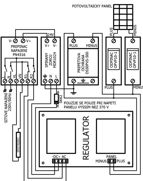
**Čtvrtý režim činnosti** – boiler na AC výstupu, který regulátor připíná externím přepínačem (pomocí DC výstupu) na síťové napětí 230 V, pokud není dost solární energie:
