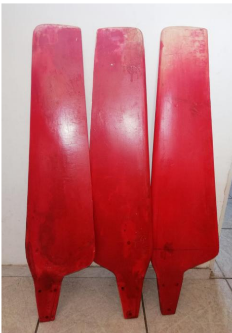
Listy rotora priemer 180 cm pred záverečnou úpravou
