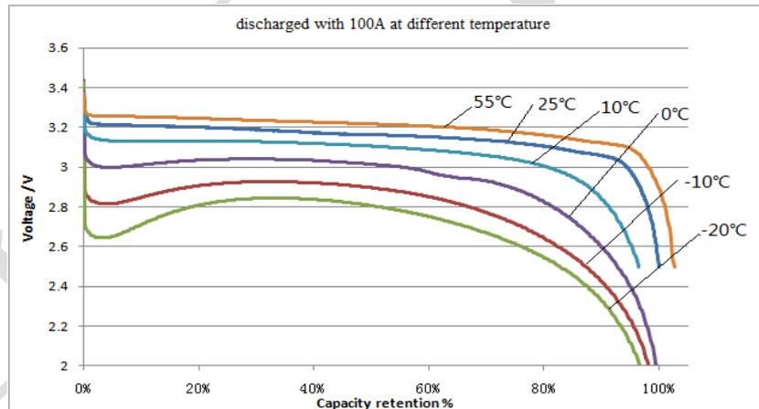
图 2. CA100 不同温度放电曲线
